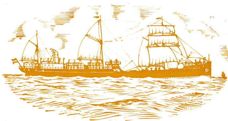
De 2.300 ton metende „Glückauf”, in 1886 in de vaart gebracht, was het eerste schip dat onverpakte olie vervoerde.
